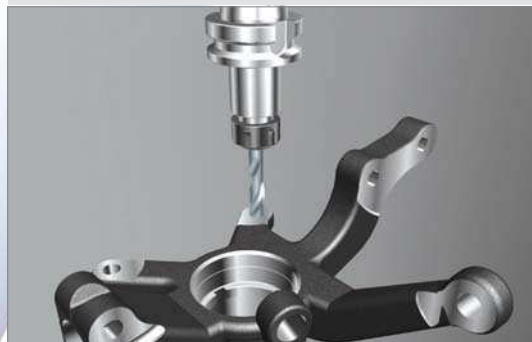
Сверление сверлами с внутренним подводом СОЖ (серия Mach Drill)
