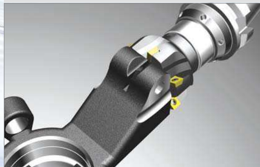
Фрезерование торца (фреза типа Future Mill)
