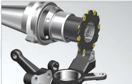
Фрезерование паза (прорезная фреза типа SPB)
