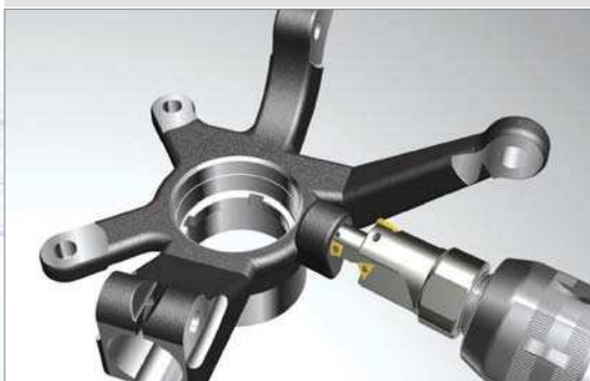
Сверление комбинированными сверлами с СМП
