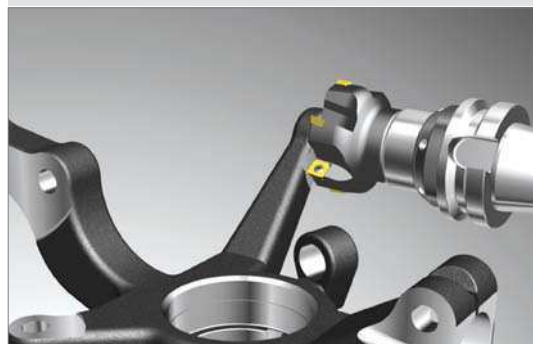
Фрезерование торца (фреза типа Future Mill)
