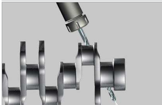
Сверление отверстия под штифт (сверла MLD)
